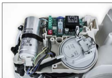
JEDNODUCHÝ PRÍSTUP KU KONDENZÁTORU, TLAK. SPÍNAČU, EL. DOSKE
