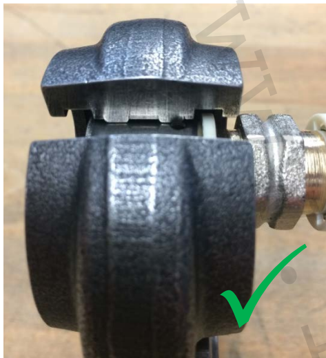
Správne usadenie čel'uste na lisovacom fittingu
