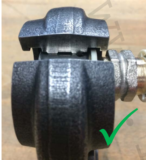
Správne usadenie čel'uste na lisovacom fittingu
