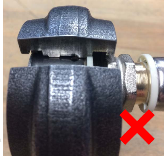
Nesprávne usadenie čel'uste na lisovacom fittingu
