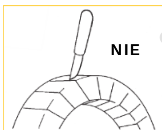
Obr. 9 – Nepovolený spôsob pri odstraňovaní obalu
