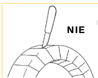
Obr. 9 – Nepovolený spôsob pri odstraňovaní obalu
