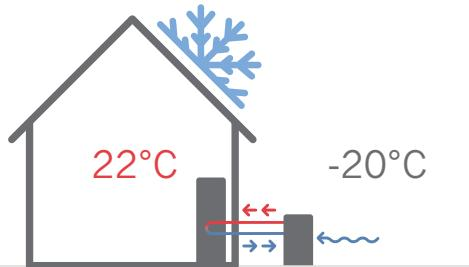
Thermia Athena využíva teplo z atmosféry tak, aby zvýšila teplotu vykurovacej vody. Teplo je potom predávané do energetického rozvodu v dome – zvyčajne do teplovodnej vykurovacej sústavy, ako je podlahové vykurovanie, vykurovacie telesá alebo fancoily – a využité tiež pre prípravu teplej vody.
